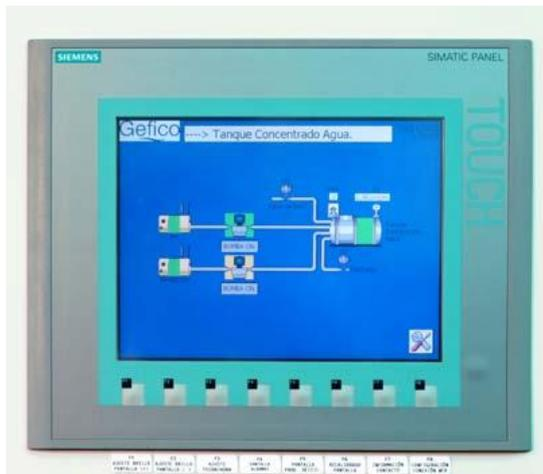
Software de control para un evaporador Gefico.
